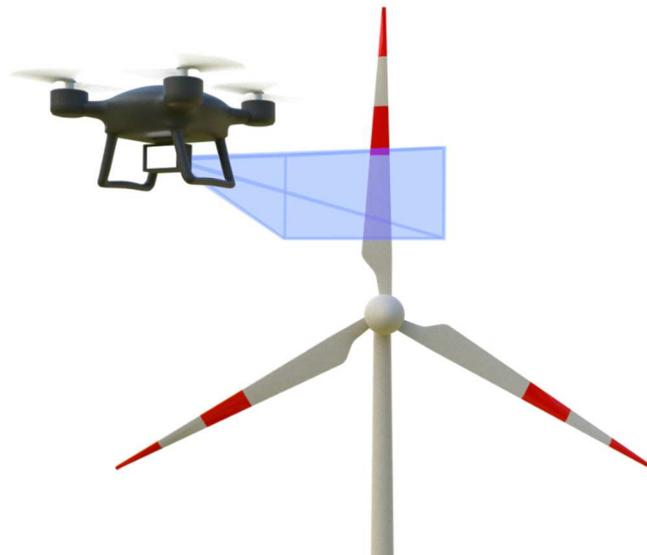
**Abbildung 7:** Wartung von Anlagen durch Roboter: Ausgestattet mit Kameras, Laserscannern und Lagesensoren sammelt die Drohne Daten, wertet sie aus und erkennt Störungen.<sup>8</sup>
