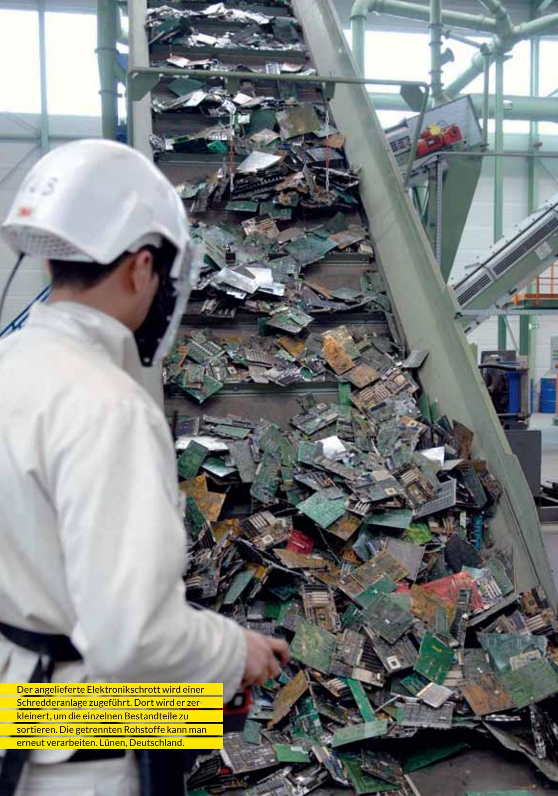
Der angelieferte Elektronikschrott wird einer Schredderanlage zugeführt. Dort wird er zerkleinert, um die einzelnen Bestandteile zu sortieren. Die getrennten Rohstoffe kann man erneut verarbeiten. Lünen, Deutschland.
