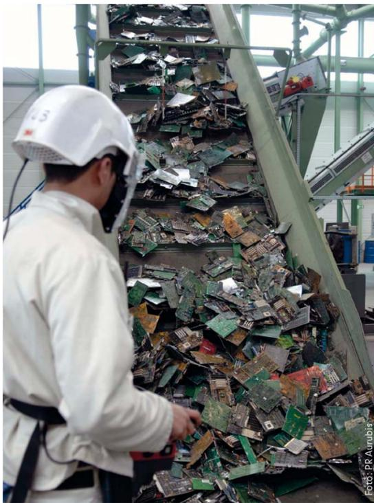
Verwertungsanlage für Elektronikschrott in Lünen.
